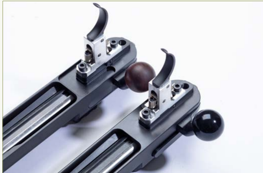
Etwas Gewicht konnte bei der HML auch an der planen Systemhülseunterseite durch eine Taschenausfräsung eingespart werden (links, rechts HM-Vorgänger).
