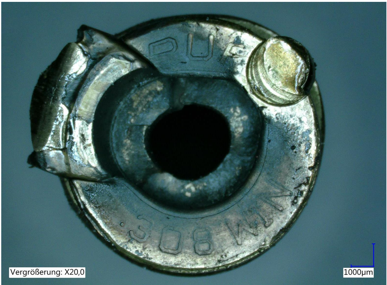
Hülsenboden nach der Entfernung aus dem Verschlusskopf
