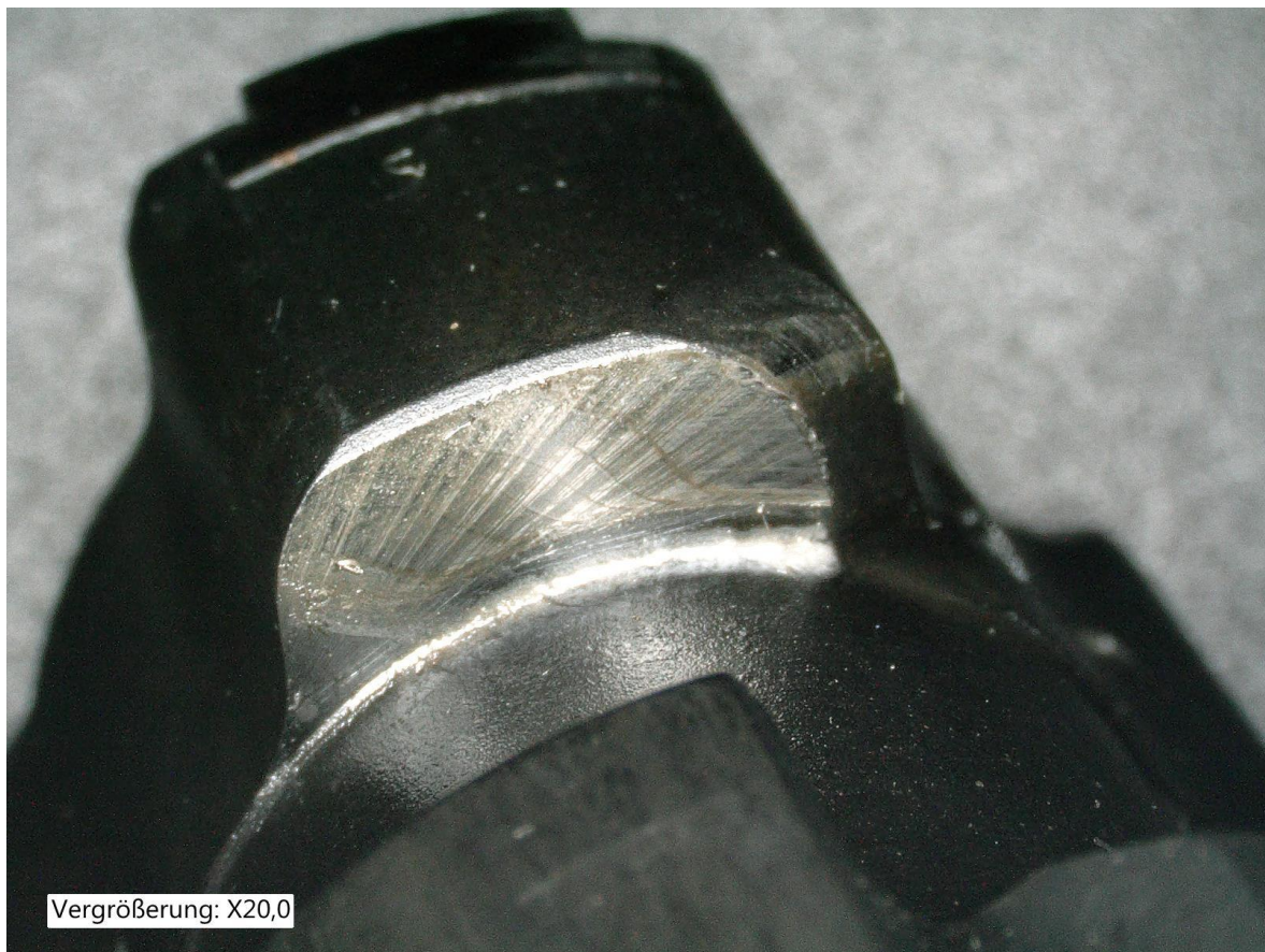
Leichte Abzeichnungen an der Verriegelung des Kammerkopfes
